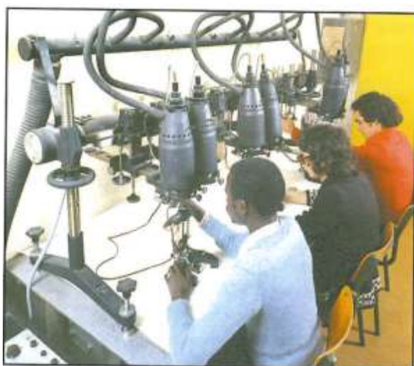
ENSG SAINT-MANDÉ Travaux pratiques de restitution photogrammétrique à l'appareil Multiplex - 1974 -
